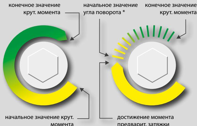
\* Установка угла поворота при комбинированном способе затяжки:
